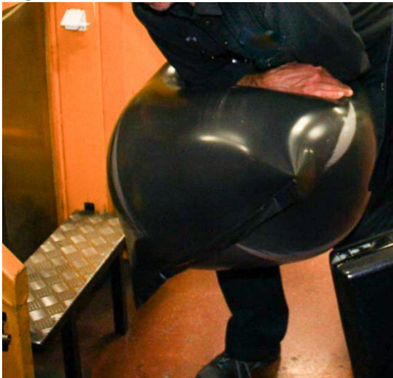
Operatören pressar ihop en uppblåst plastpåse för att testa svetsfogen i samband med ett studiebesök hos en större tillverkare av plastpåsar.
