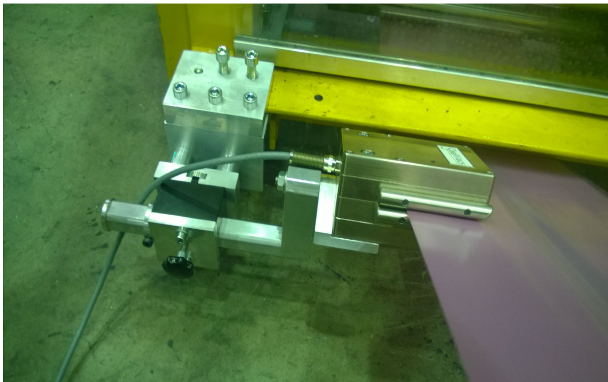
Sensorn monterad i en produktionslinje för utprovning under pågående tillverkning av plastpåsar på rulle
