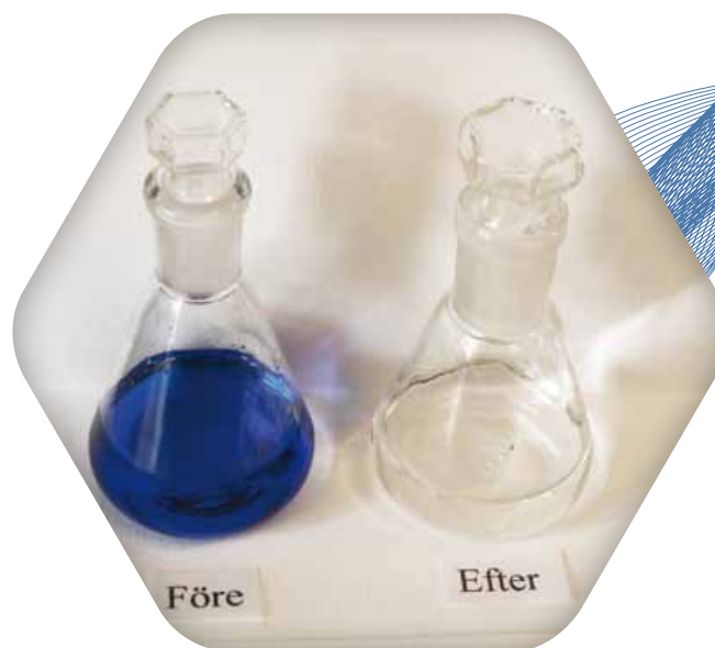
Effekt av EcoFilter på en djupblå vattenlösning. Efter rening är lösningen helt klar.
