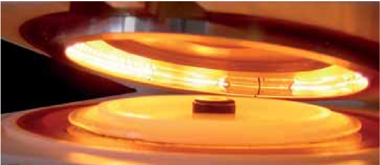
AlphaHelix instrument värmer de roterande proverna med en cirkulär infraröd radiator under PCR-reaktionen.
