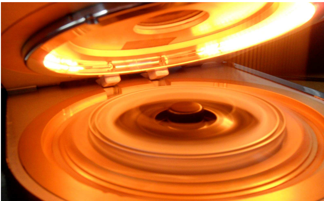
AmpXpress värmer de roterande proverna, den cirkulära infraröda radiatoren syns upptill
